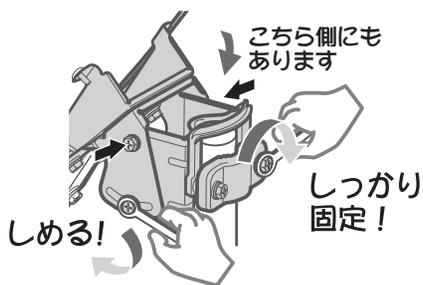
アンテナの方向・角度がずれないように各固定ボルトを均一に少しずつ締め付けていきます。
