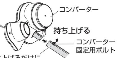
コンバーターを差し入れる際、ボルトは持ち上げるだけにしてください。回すと抜け落ちることがあります。
