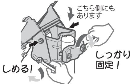
アンテナの方向・角度がずれないように各固定ボルトを均一に少しづつ締め付けていきます。
