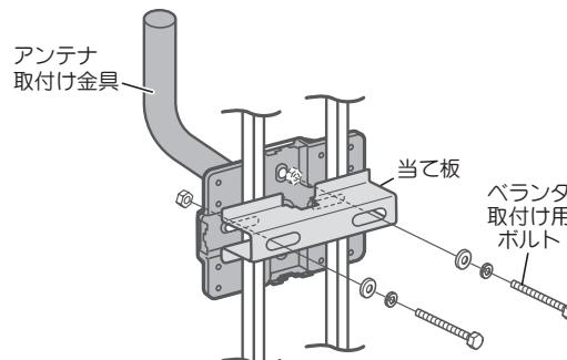
**ココを確認!** 取付け金具が地面と水平・垂直になるよう取付けてください。
