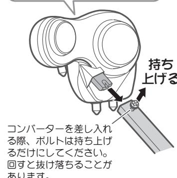
4 コンバーターアームをアンテナマウント部のくぼみに差し込み、固定用ボルトで固定します。
