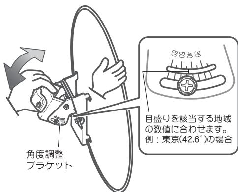
2 合わせた角度がずれないように固定ボルト4本をめがねレンチ(10mm)で仮締めします。
