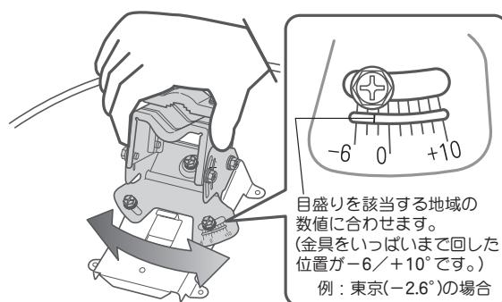
3 ゆるめた固定ボルト3本をめがねレンチ(10mm)で締めつけてください。
