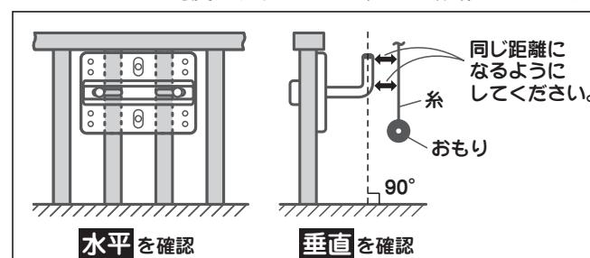
2 水平・垂直を確認したら、めがねレンチ(13mm)でボルトをしっかりと締めつけます。
