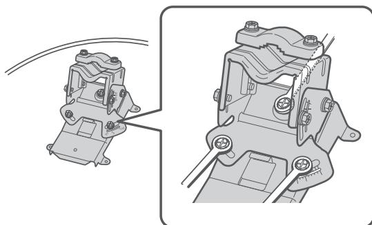
2 右ページ下部のディッシュ傾斜角・仰角マップを参照し、ディッシュを机の上などに置いて金具を左右に回し、傾斜角の目盛りを該当する地域の数値に合わせます。
