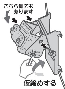
3 コンバーター固定用ボルトを持ち上げながら、コンバーターアームにコンバーターを差し込み、めがねレンチ(10mm)で締め付けて固定します。
