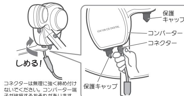
2 同軸ケーブルの防水キャップをコンバーター側に確実に押し込んでください。防水キャップがずれていると、雨水が入って受信不良になります。
