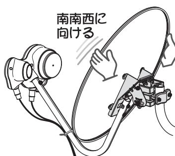
4 合わせた方向がずれない程度にアンテナ固定ボルト(M6)2本を仮締めします。(めがねレンチ(10mm)をご使用ください。)
