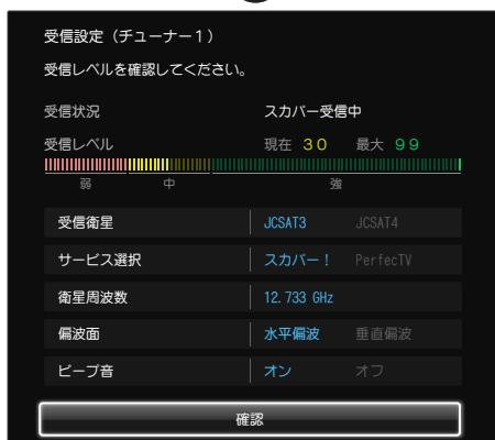
13 受信状況を確認しながら、アンテナの方向を調整する
