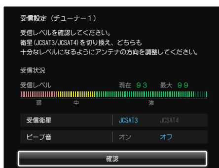
**10 受信状況を確認しながら、アンテナの方向を調整する**
