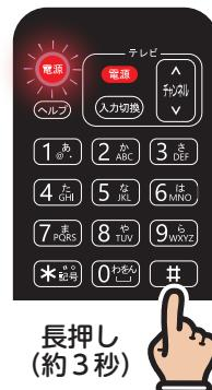
リモコンの電源ランプが2回点滅したあと点灯します。
