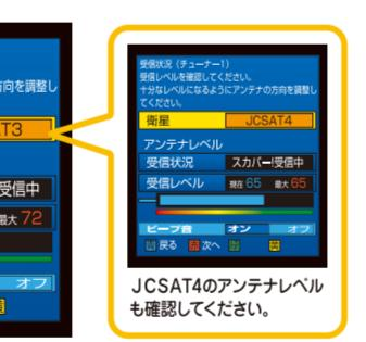
アンテナの信号受信レベルの設定を行います。2つの衛星の受信レベルを確認・設定してください。
